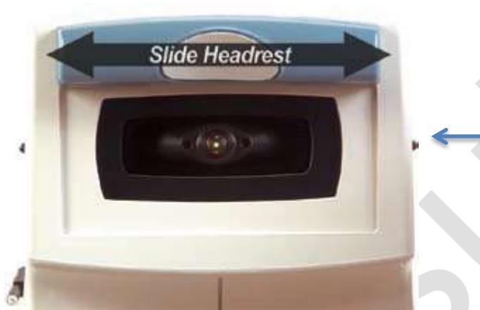
**Étape 4:** Ajustez l'appui-tête vers la droite ou vers la gauche; cela permettra au logiciel de déterminer automatiquement quel œil est à mesurer. L'appareil doit être positionné complètement d'un côté ou de l'autre afin d'effectuer une mesure. Commencez avec **l'œil droit**, en glissant l'appui-tête vers la gauche du participant.
