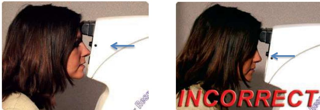
Le participant doit se pencher légèrement vers l'avant de sorte que le centre de son front repose au centre du coussin en caoutchouc. La tête du participant doit toucher l'appui-tête directement, alignée perpendiculairement avec l'avant de l'appareil (et non tournée vers le côté). De plus, le nez et le menton du participant devraient être tournés vers l'intérieur, vers la surface avant de l'appareil. Le participant doit être capable de voir la lumière verte.
